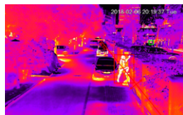
Detekcja przekroczenia linii (termiczne)
